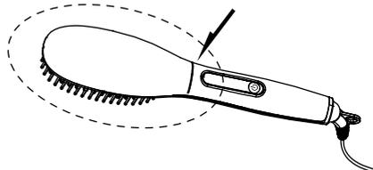
電源ボタンを長押しする 160°C で点滅 (温度上昇中は点滅しています) ボタンを押すごとに 160~230°C まで 10°C 単位で切り替わります。設定温度に達すると点灯に変わります。
