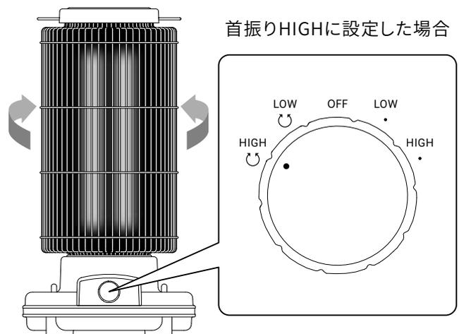
運転切り替えツマミを1段階左に回しますと、LOWの状態です振り機能が使えるようになります。
