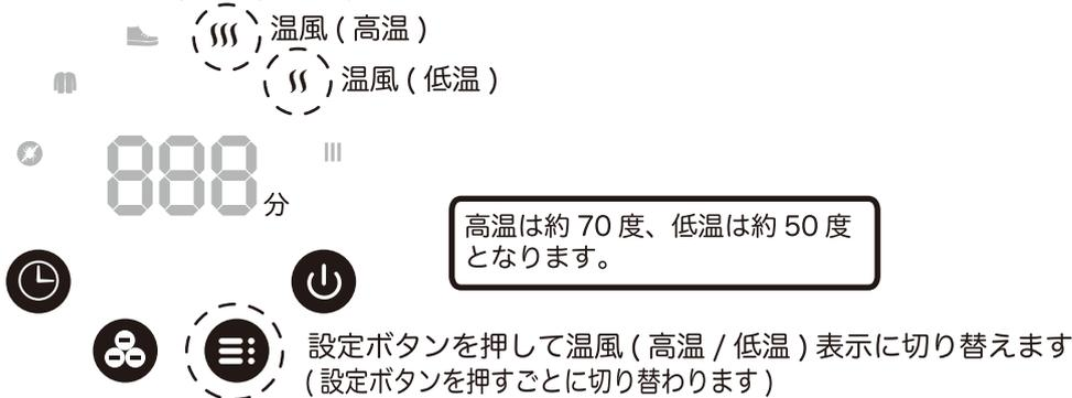
④タイマーボタンを押して時間の設定をします。時間は 30/60/90/120/150/180 分で設定できます。推奨時間は 30 分です。また時間表示が点滅している間に操作をおこなってください。点滅から点灯に変わると操作ができなくなります。
