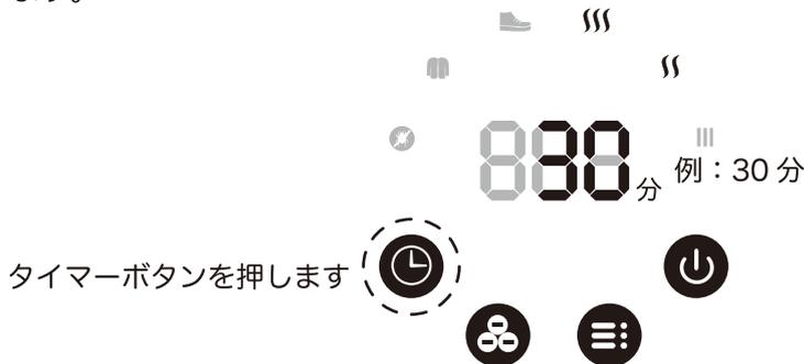
⑤送風が始まります。設定した時間が経過すると自動的に運転を停止します ( ヒーターやホースを冷却するために約 30 秒送風します )。
