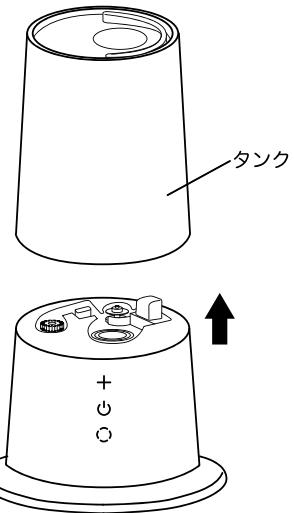
1-3 タンク裏側のキャップを左に回して外します。
