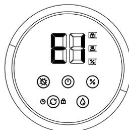
水タンクの水が切れた際、もしくはタンクを外した際は、表示パネルに「E1」が点滅します。
