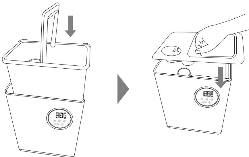
※水タンクが正しくセットされていることを、必ず確認してください。水漏れの恐れがあります。
