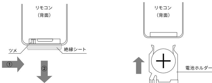
電池はリチウム電池CR2025を使用し、電池をセットする際、表と裏を間違えないでください。
