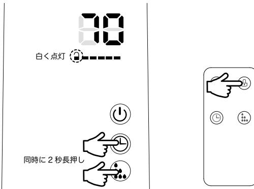
設定完了後ボタンが5秒間点灯し、その後消灯します。
