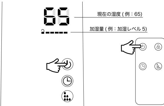
設定完了後ボタンが5秒間点灯し、その後消灯します。
