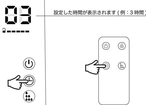
操作中と設定完了後ボタンが点灯します。
