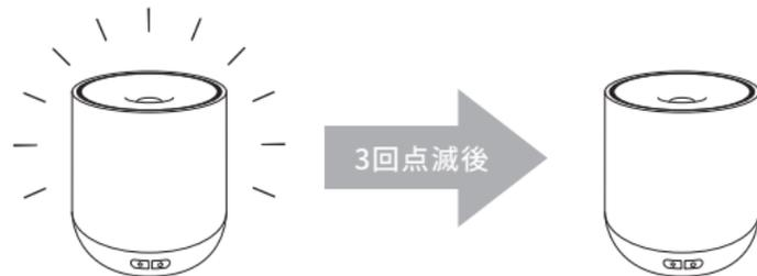
水タンク内の水が無くなった場合、ライトが3回点滅し、その後、空運転防止のため、自動的に電源がOFFになります。
