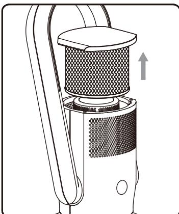
古い空気清浄フィルターを持ち上げて取り外します。
