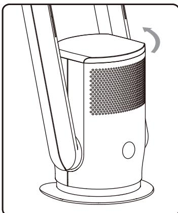
空気清浄フィルターの上部カバーを反時計回しに回してフィルターのロックを解除して取り外します。
