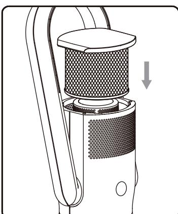
空気清浄フィルターを取り外したのと逆の手順（上部カバーを時計回しで固定）で新しい空気清浄フィルターを取り付けます。
