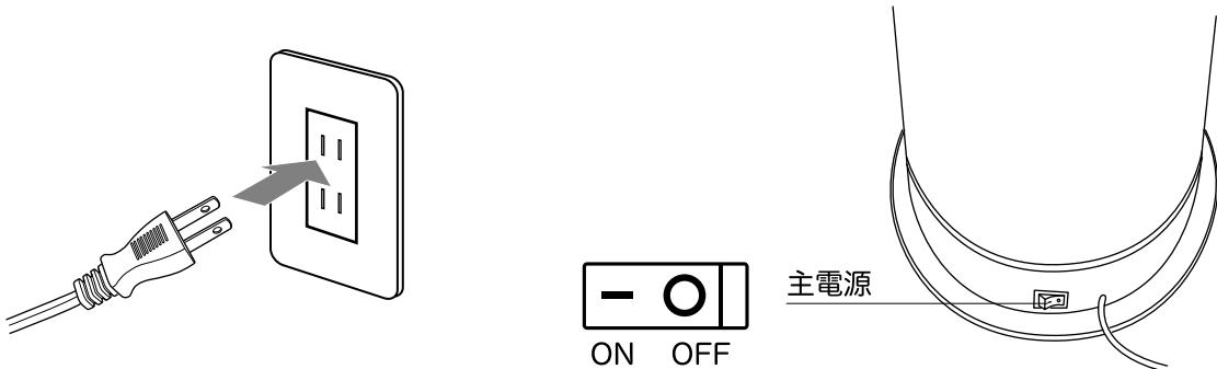
背面のスイッチが主電源となりますので、使用しない場合は背面のスイッチを OFF にしてください。
