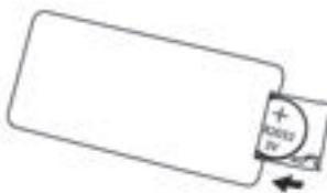
※長時間使用しない時は電池を取り出してください(液漏れによる故障を防ぎます)。
