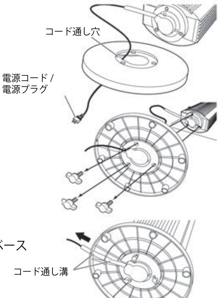
電源コードは右図のようにスタンドベース底面のコード通し溝に確実に通してください。
